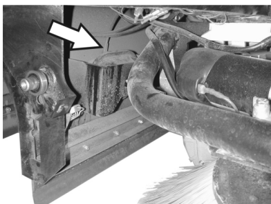
Підключення шлангів до мембранного механізму вакуумного регулятора системи опускання бічної щітки.
