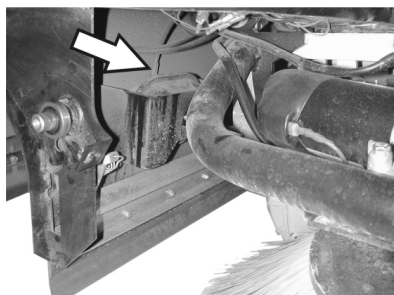
Conexión de manguera para diafragma controlado por vacío del dispositivo de descenso de escoba lateral
