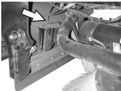
Przyłącze węża do puszkii podciśnieniowej mechanizmu opuszczania miotły bocznej
