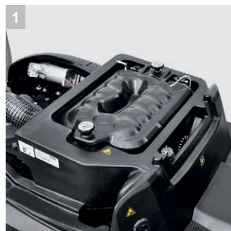
**1 Система непрерывной автоматической очистки фильтра Tact.**
