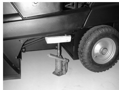
Точка установки домкрата (задние колеса)
