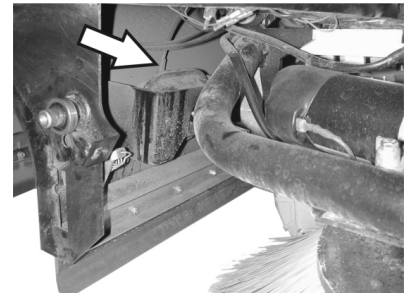
Schlauchanschluss zur Unterdruckdose der Seitenbesenabsenkung
