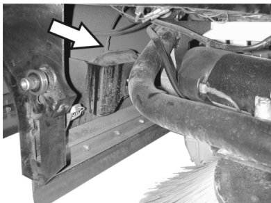
Slanganslutning till undertrycksdosor för sänkning av sidoborstar.
