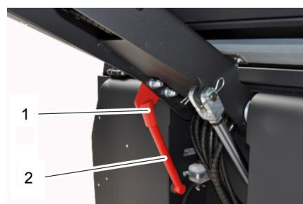
1 Держатель предохранительной штанги
