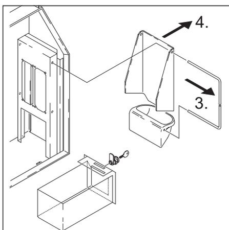
→ Abgewinkelten Scharnierstab hinter der Abkantung der Öffnung mit Schraubendreher „heraushebeln“ und herausziehen.
