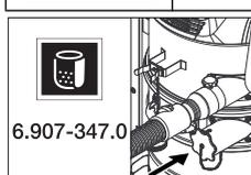
*При использовании мешка для сбора отходов нижний всасывающий патрубок должен быть плотно закрытым.*
