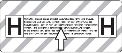
WIKUNG: Dieses Gerät enthält geschädigte/verformte Stäube, Entleerung und Wartung, einschliesslich der Entleerung des Staubbehälters, dürfen nur von geschulten Personen vorgenommen werden, die geeignete persönliche Schutzvorrichtung tragen. Nicht einschalten, bevor das komplette Filtersystem installiert ist und die Funktion der Ventile durch Kontrolle überprüft wurde.
