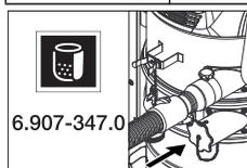
*Durante a utilização do saco descartável, é necessário que o bocal de aspiração inferior esteja fechado estanqueamente.*
