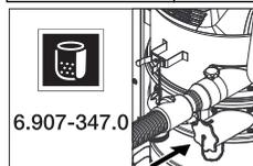
*Bei Verwendung des Entsorgungsbeutels muss der untere Saugstutzen dicht verschlossen sein.*
