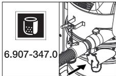
*Hävityspussia käytettäessä alemman imuletkuliitännän tulee olla tiiviisti suljettuna.*
