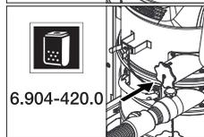
*Bij gebruik van de veiligheidsfilterzak moet de bovenste zuigopening dicht afgesloten zijn.*
