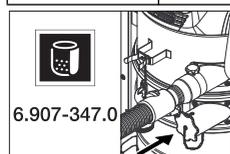
*Si se utiliza una bolsa de desechos, el manguito de aspiración inferior tiene que estar cerrado herméticamente.*
