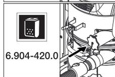
*V případě použití bezpečnostního filtračního sáčku musí být horní sací hrdlo těsně uzavřeno.*
