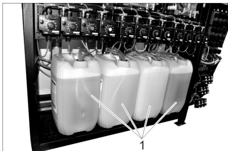
1 Bidon de détergent Cire chaude Top finition Détachement de saletés Lavage haute pression / mousse humide
