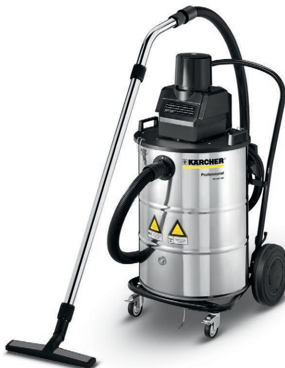
Безопасный пылесос NT 80/1 B1 M позволяет избежать риска возможного взрыва пыли. Горючие пыли и вредная пыль класса М должны быть отсосаны немедленно из-за риска накопления. Для отсасывания такой пыли необходимо применять пылесос, имеющий систему безопасности B1, такой как NT 80/1 B1 M (Европейская директива 94/9 EC (ATEX)).
