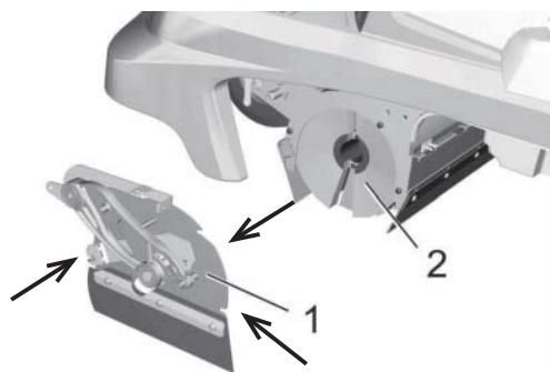
サイドカバーセットを前方に 10 mmほどずらしロックピン（矢印）を解除します。
