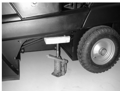
Точка установки домкрата (задние колеса)
